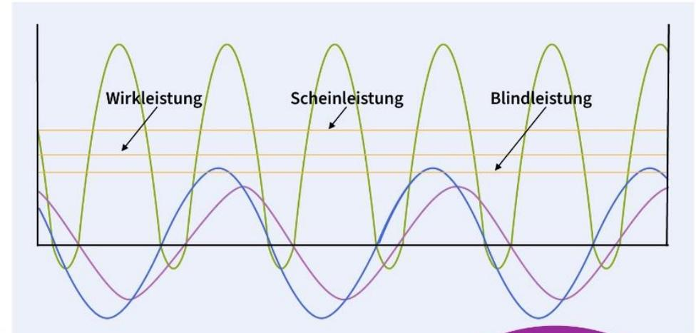
Maschinen, Beleuchtungssysteme oder Klimaanlage benötigen Wirkstrom, der über Freileitungen aus einem Kraftwerk geliefert wird. Viele dieser elektrischen Geräte erzeugen Blindstrom. Dieser fließt periodisch zwischen dem Generator im Kraftwerk und dem Verbraucher hin und her. Aus diesem Grund erfassen die Energiezähler sowohl den Wirkstrom als auch den Blindstrom.
